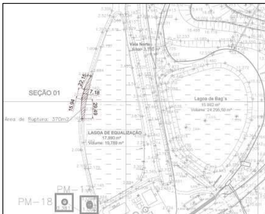
Figura 79 – Dimensões da área rompida.
